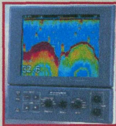
В учетных работах 2011 г. использован рыбопоисковый эхолот Fujino FCV-1100L с рабочими частотами 200 и 28 кГц (модернизированный в ЛИИ СО РАН)
