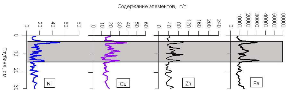
Рис. 6. Содержание Ni, Cu, Zn и Fe в верхнем слое донных отложений залива Провал (оз. Байкал)
